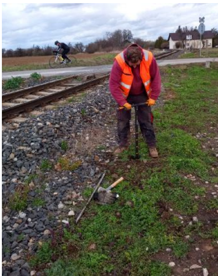
Místo realizace vrtu V1 pro realizaci nálevové zkoušky.
