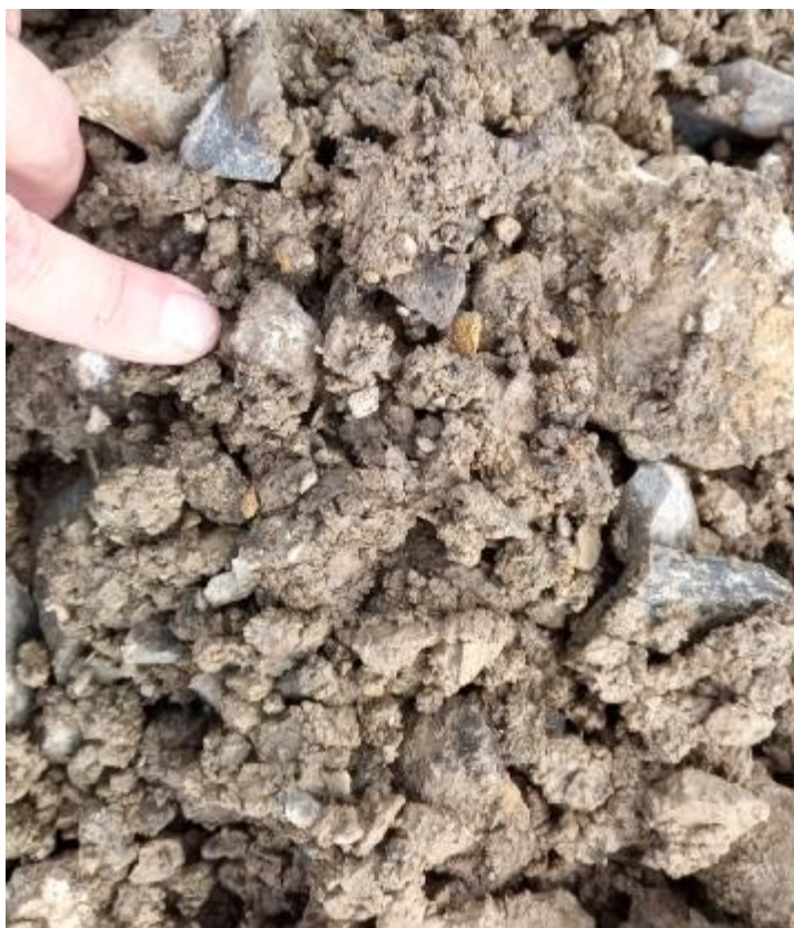
Detail zeminy v podloží štěrkového lože. Pravděpodobně se jedná o znečištěnou štěrkodrt' (jíl kašovitě konzistence)
